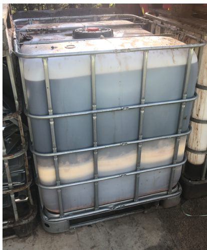
Bilde 5: Umerket IBC med farlig avfall. Denne IBC var oppsamling av rester av farlig avfall mottatt i IBC-er fra en kunde.
