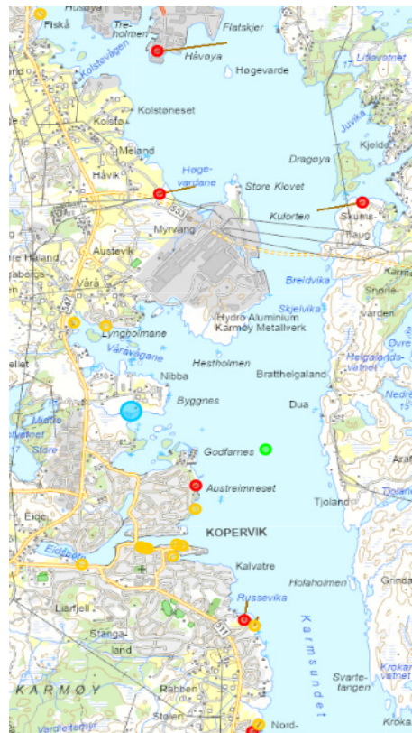
Figur 1 - Eksisterende renseanlegg (rød) og delutslipp (oransje) som skal samles til et felles utslipp (grønn) fra RA Kopervik (blå). Kartgrunnlag: Temakart Rogaland.
