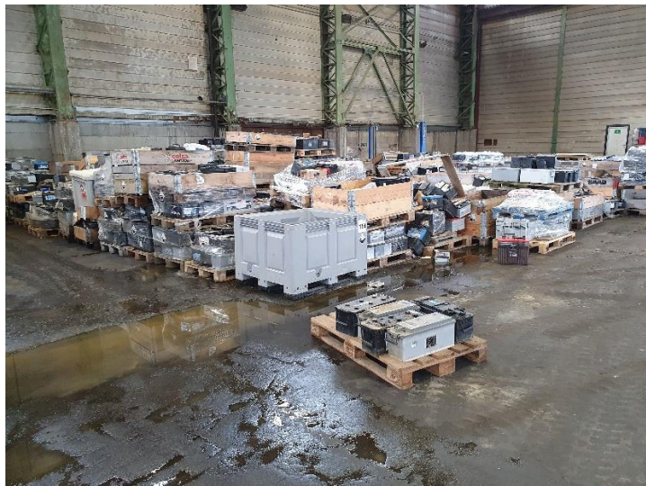
Bilde 2 Lagring av kasserte blybatterier i hall.
