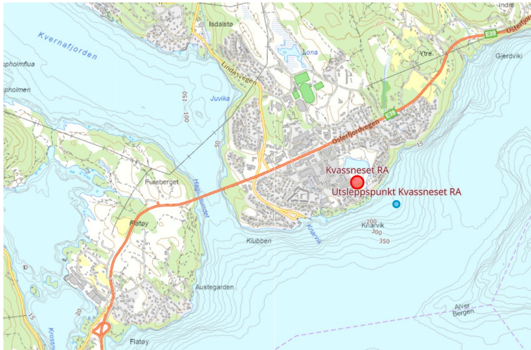
Figur 1: Kartutsnitt frå Fylkesatlas.no. Planlagt plassering av reinseanlegget er vist med raud sirkel, og omtrentleg plassering av utsleppspunktet med blå sirkel. Utsleppspunktet er planlagt på om lag 60 meters djupne og 200 meter frå land.
