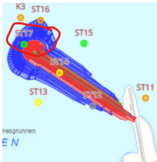
Figur 2: Området i nordøstre del av søndre molohode som ikke er tilstrekkelig geoteknisk stabilt for overdekningslag.
