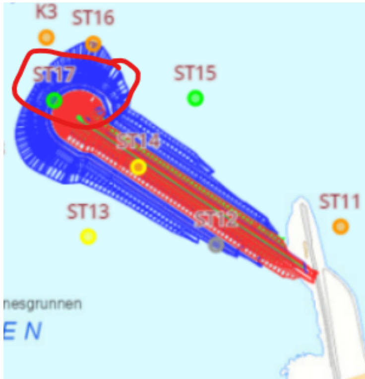
Figur 1: Området i nordøstre del av søndre molohode som ikke er tilstrekkelig geoteknisk stabilt for overdekningslag.
