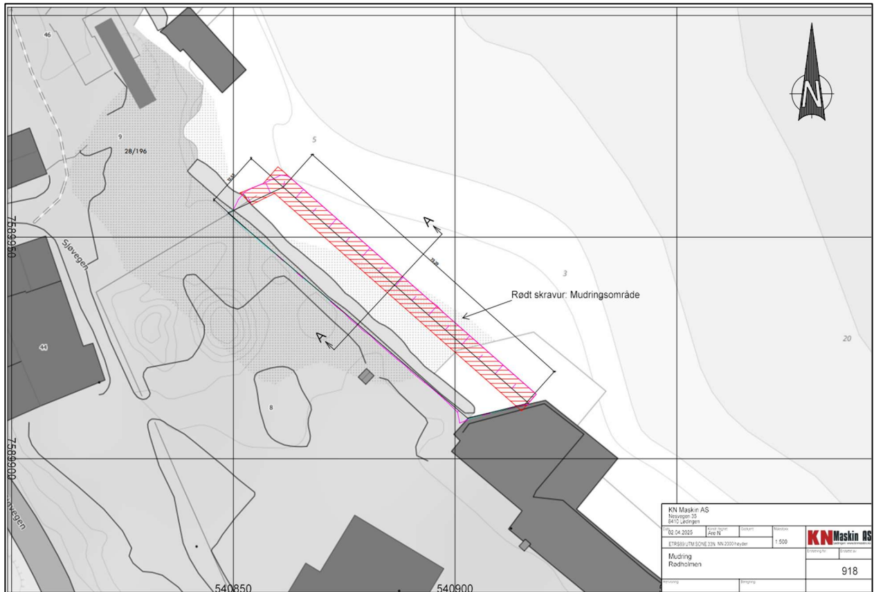
Figur 1. Oversikt over utfyllingsområdet i sort skravur, estimert fyllingsfot innenfor lilla skravur. Rødt skravur er mudringsområdet. Illustrasjonene er hentet fra søknaden.
