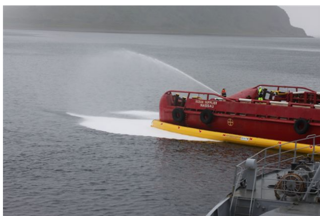
Utlegging av skum som skal fanges inn i sveplense
