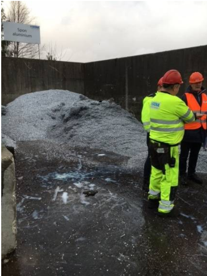
Metallspon i bingje med avrenning av «skjærevæske» til sjø via oljeavskiller.
