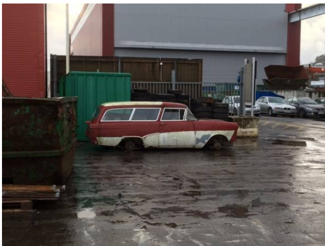
Lagring av bilvrak som ikke er miljøsanerte på dekke som ikke er tett eller har oppsamling av søl/avrenning
